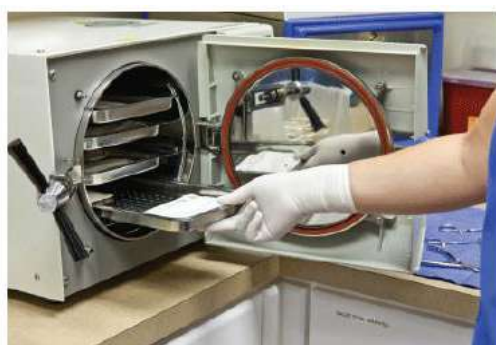
Gambar 9. Sterilisasi menggunakan (a) panci tekan dan (b) autoklaf
